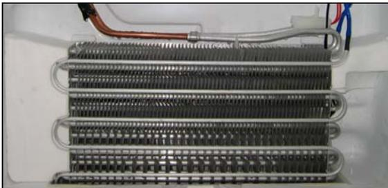
La Resistencia Deshielo envuelve toda la extensión del Evaporador, garantizando un mejor rendimiento del sistema y está fija a través de las trabas existentes en el Evaporador. Su operación (conectar/desconectar) también es comanda por la Unidad de Control y sus características eléctricas pueden verificarse en la tabla a continuación:
